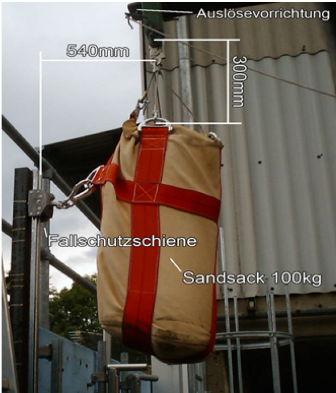
Abb1. Positionierung des Prüfgewichts
