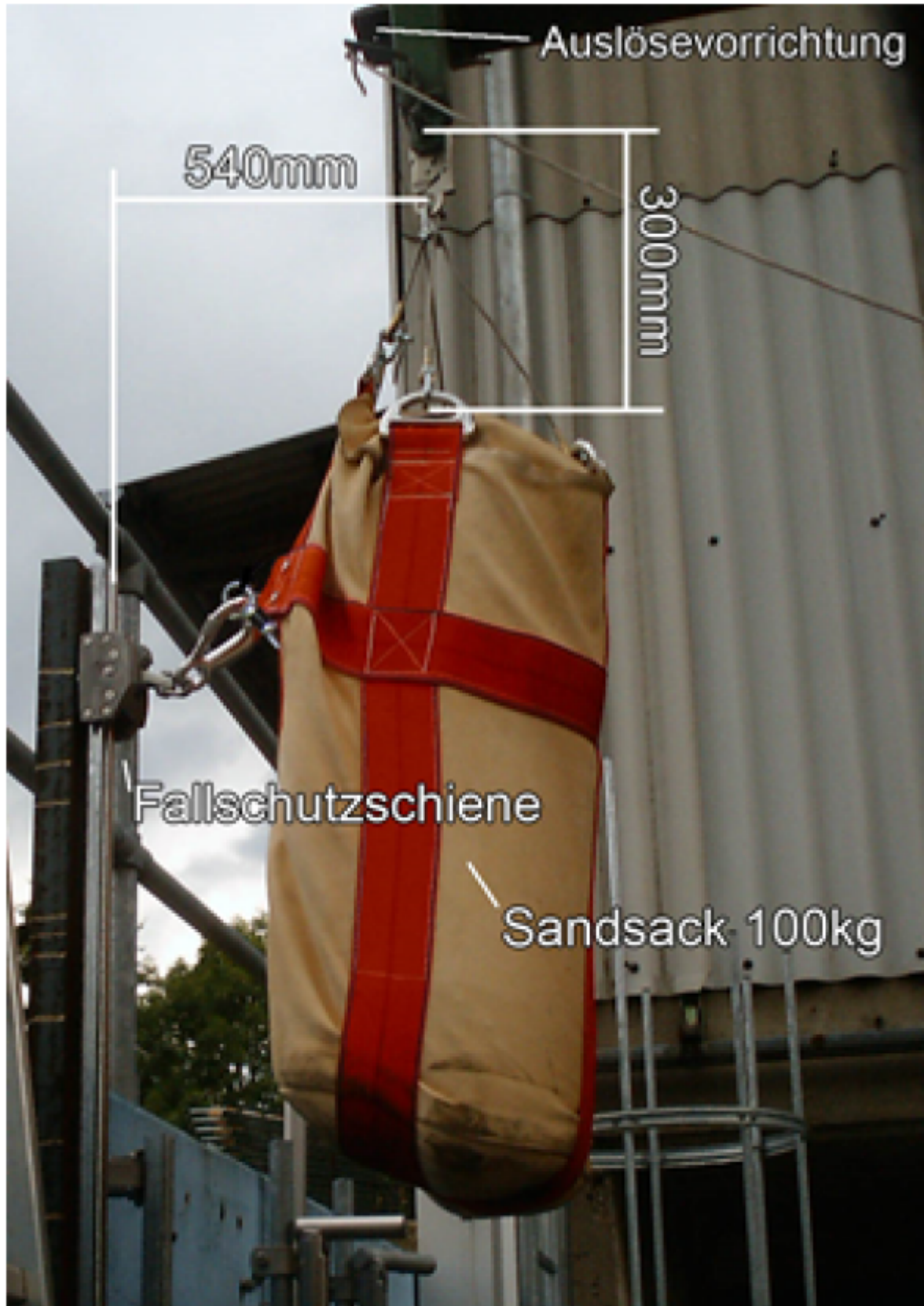
Abb2. Positionierung der Prüfgewichts
