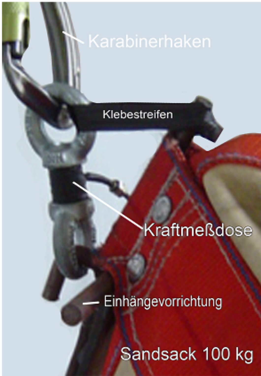
Abb1. Sandsack mit Einhängestange und Kraftmessdose
