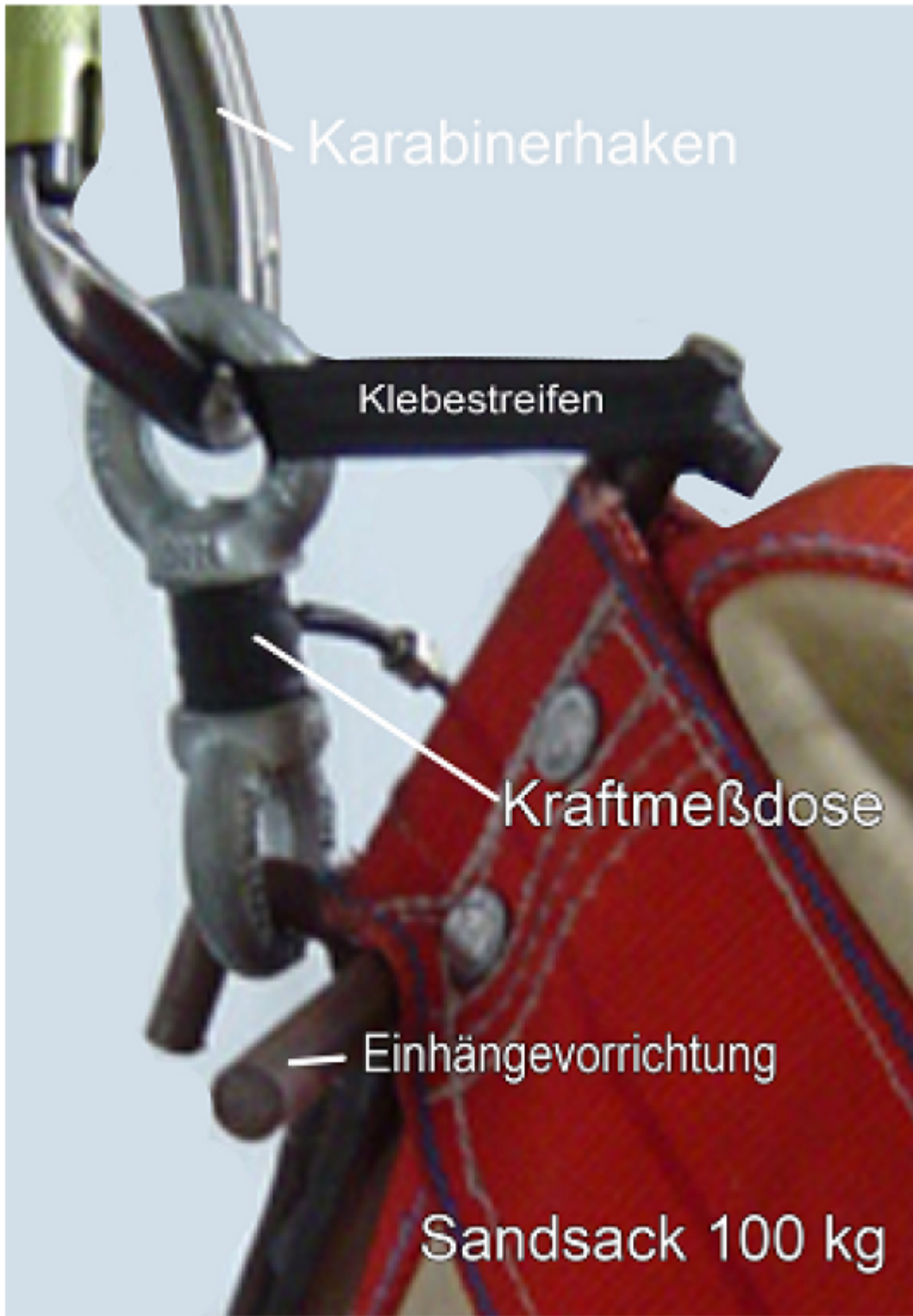
Abb1. Sandsack mit Einhängestange und Kraftmessdose
