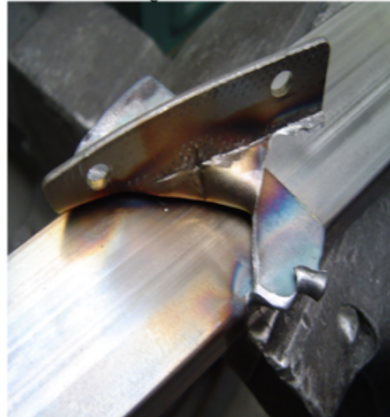
Bild Nr.4 Der Stufenwinkel ist gerissen.
