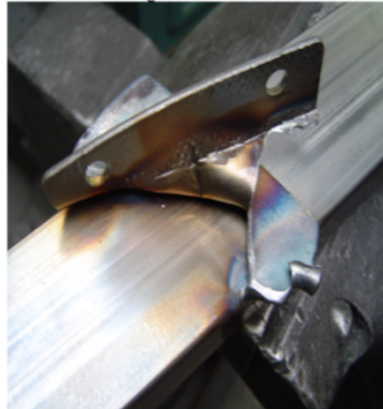
Bild Nr.4 Der Stufenwinkel ist gerissen.
