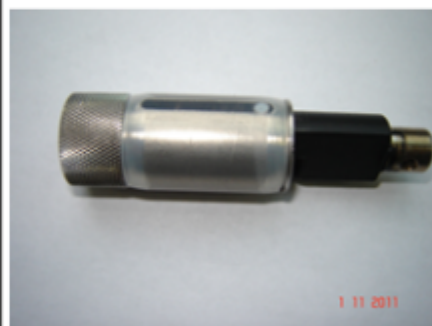
Bild Nr.6 Fertig geschrumpfter Schlauch.
