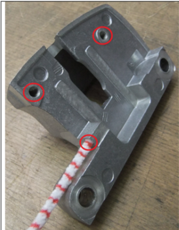
Foto 1: Griffteil (26/5242) mit markierten Punkten, die gereinigt werden sollen
