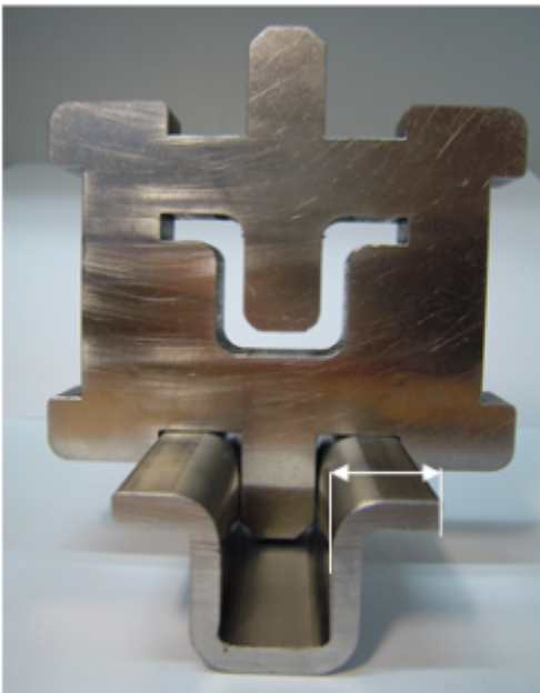
Bild Nr.2 Ermitteln Größt-/ Kleinstmaß, Flanschbreite.
