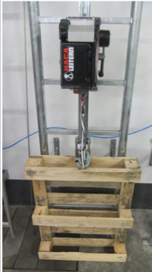
Abbildung 12: Vorrichtung für Klettertest
