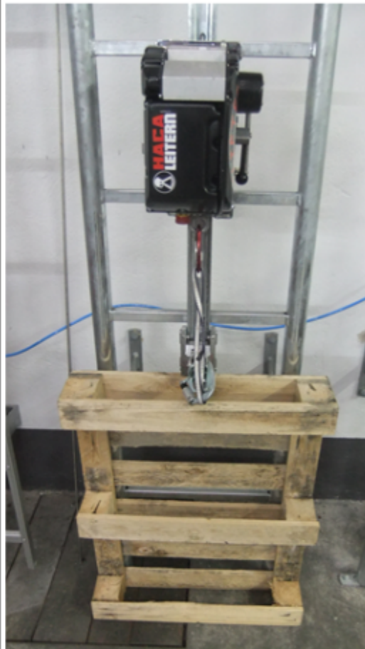
Abbildung 12: Vorrichtung für Klettertest
