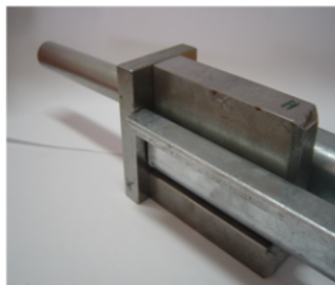
Bild Nr.3: Prüflehre bis zum Anschlag aufstecken.
