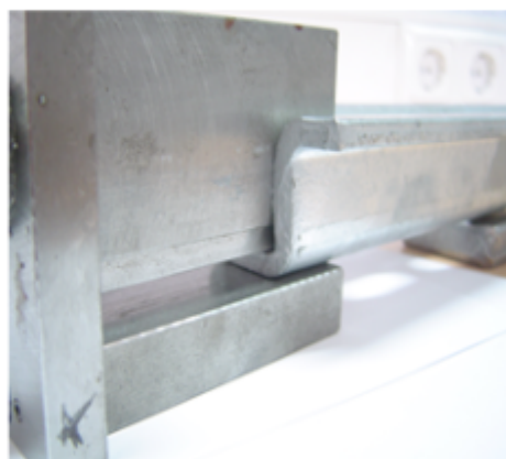
Bild Nr.2. Ansetzen der Prüflehre.
