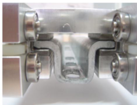
Bild Nr.3 Prüflehre- Aufschieben.
