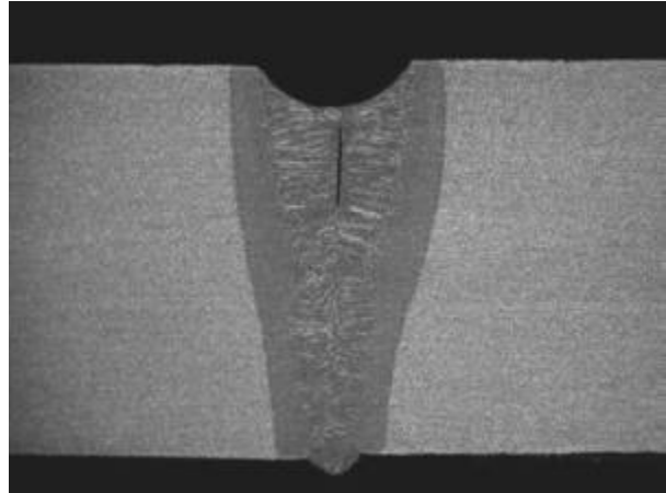
Bild 11: Interdendritischer Lunker einer Elektronenstrahlschweißnaht
