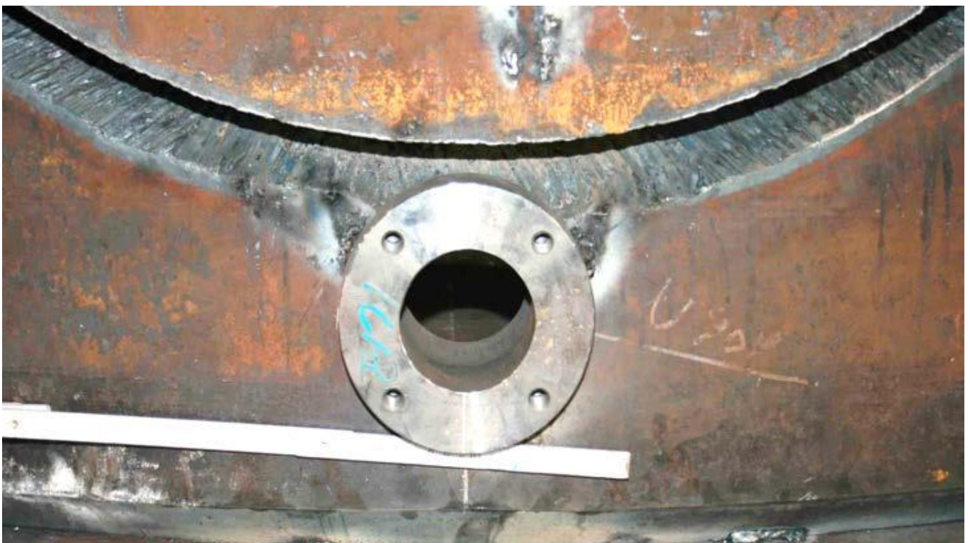
Bild 3: Nahtvorbereitung mangelhaft, Schweiß- und Zusammenbaufolge nicht beachtet.
