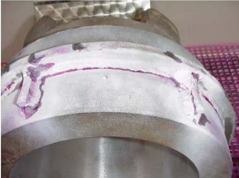
Bild 12. Bindefehler zur Oberfläche hin offen
