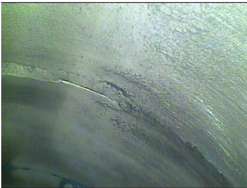
Bild 12. Bindefehler zur Oberfläche hin offen
