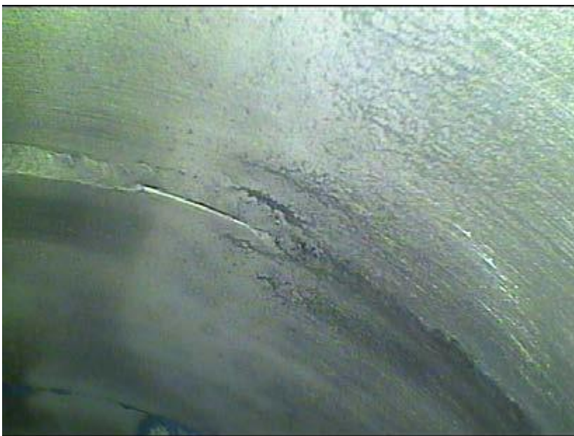
Bild 12. Bindefehler zur Oberfläche hin offen
