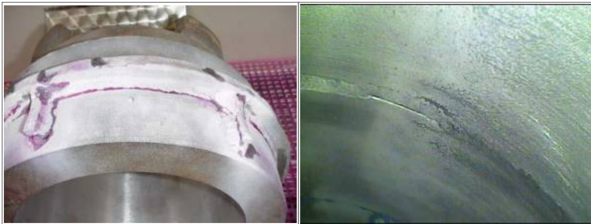
Bild 12. Bindefehler zur Oberfläche hin offen
