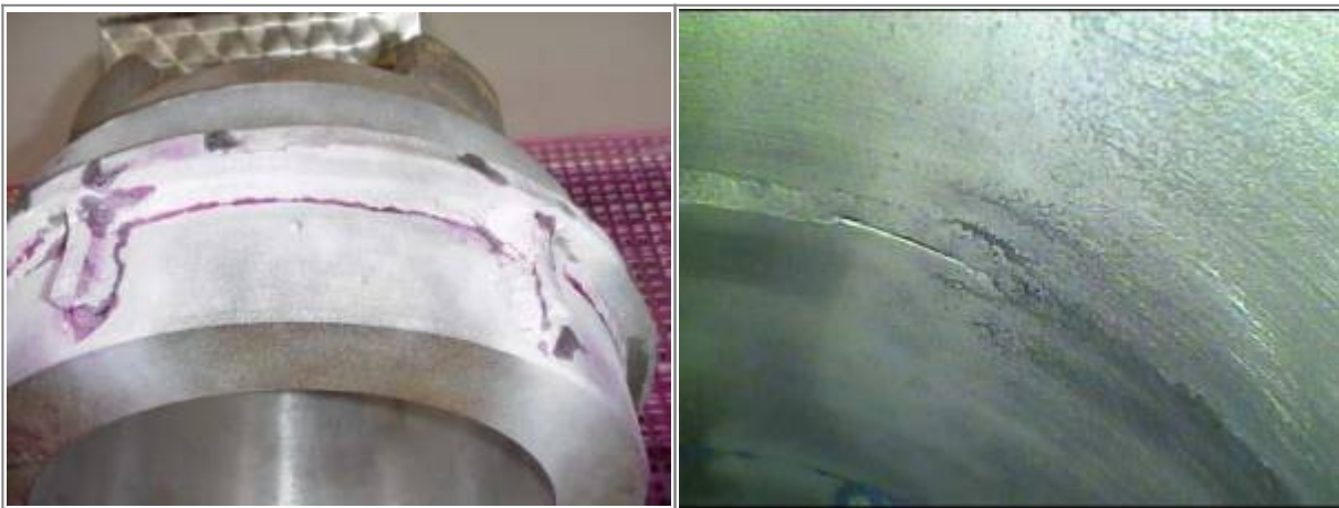
Bild 12. Bindefehler zur Oberfläche hin offen
