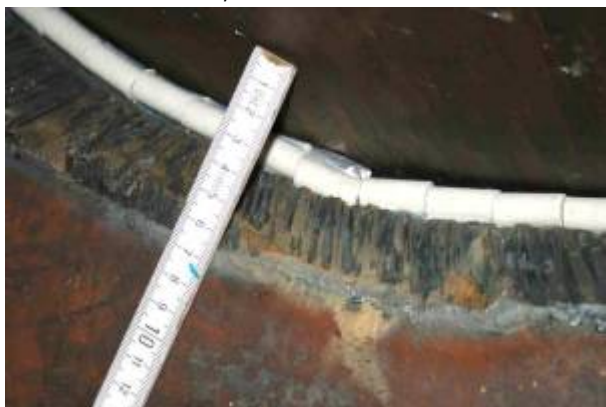
Bild 2: Nahtvorbereitung mangelhaft..... Bild 3: Nahtvorbereitung mangelhaft, Schweiß- und Zusammenbaufolge nicht beachtet.
