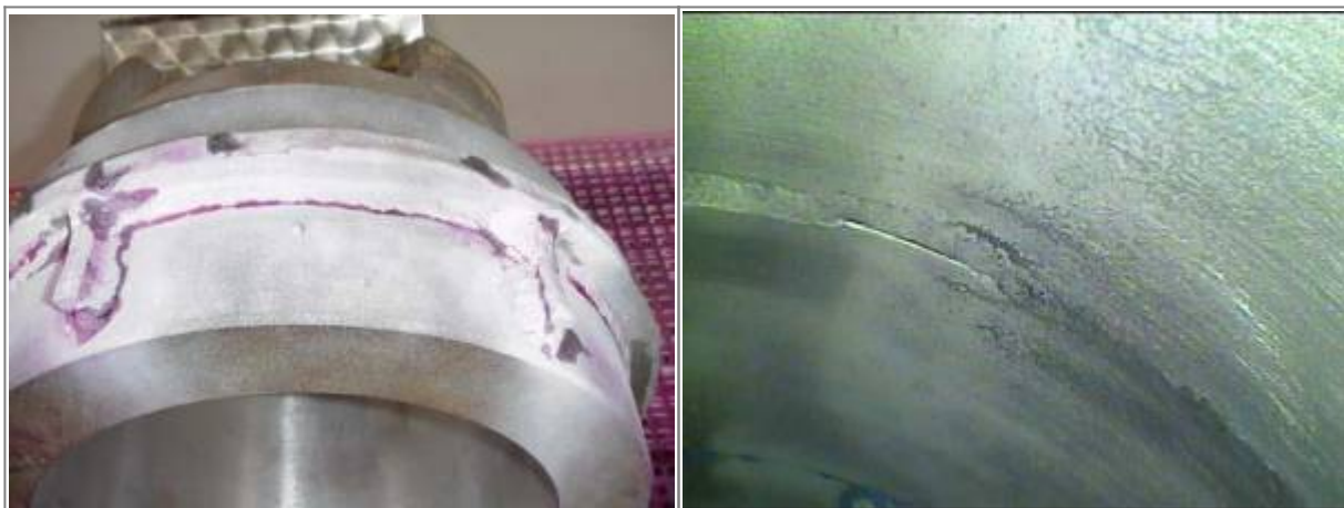
Bild 12. Bindefehler zur Oberfläche hin offen
