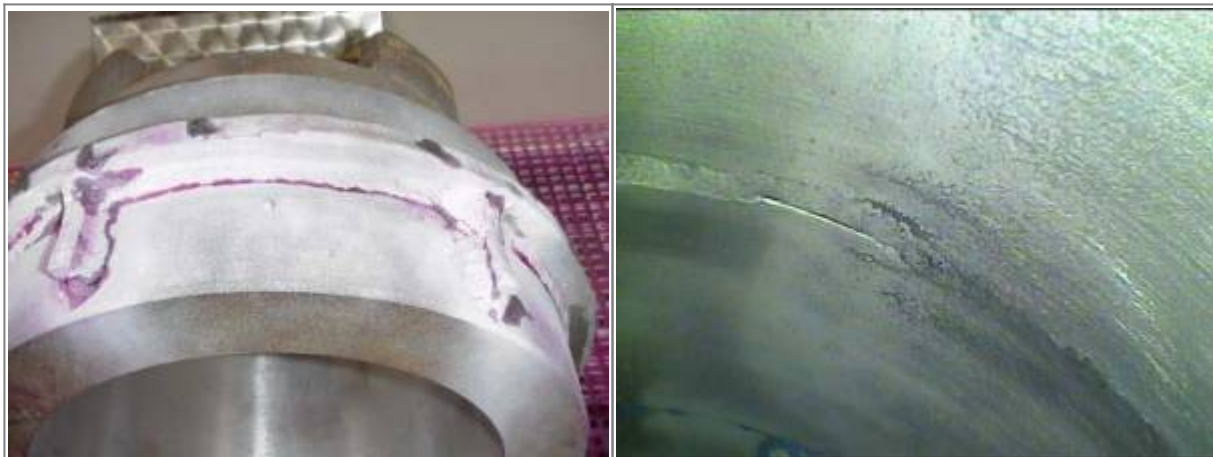
Bild 12. Bindefehler zur Oberfläche hin offen
