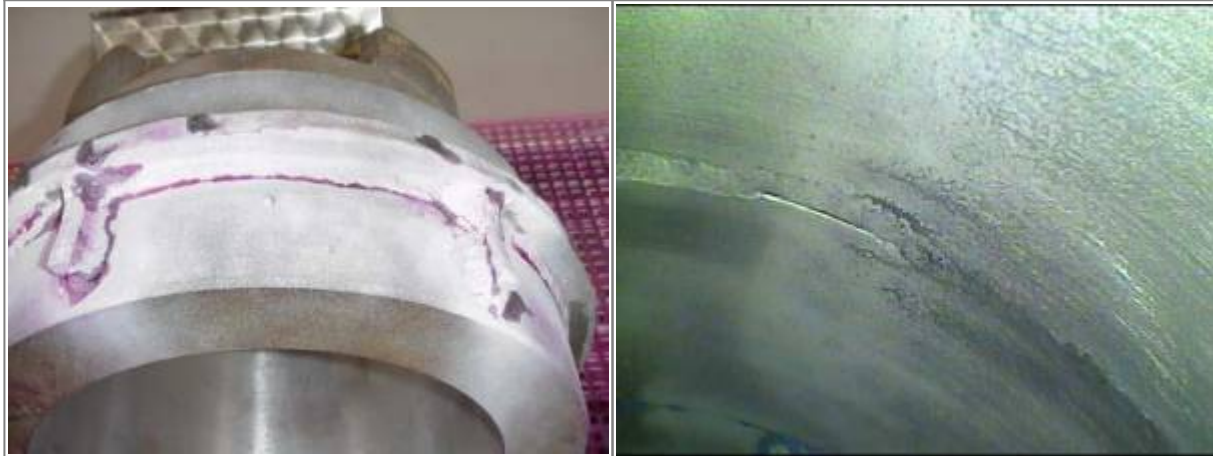
Bild 12. Bindefehler zur Oberfläche hin offen
