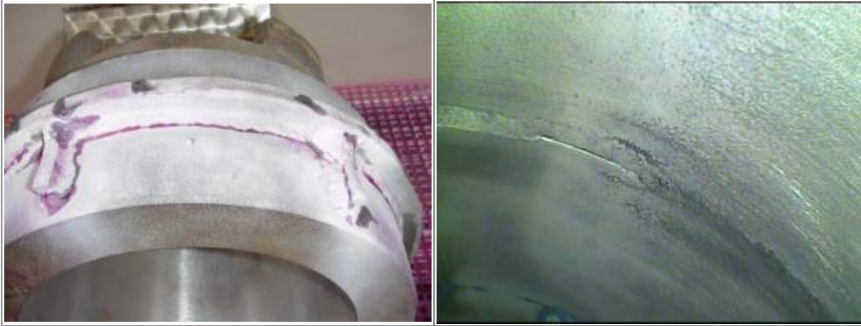
Bild 12. Bindefehler zur Oberfläche hin offen
