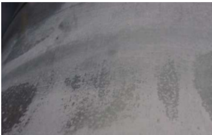
Abb.2: Flächiger Weißrost auf einem Verzinktem Blech
