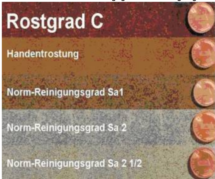
Bild 4: Versch. Vorbereitungsgrade bei Ausgangszustand C
