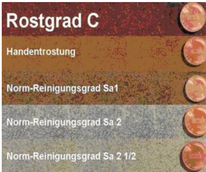
Bild 4: Versch. Vorbereitungsgrade bei Ausgangszustand C
