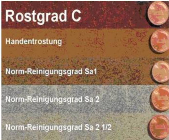
Bild 4: Versch. Vorbereitungsgrade bei Ausgangszustand C
