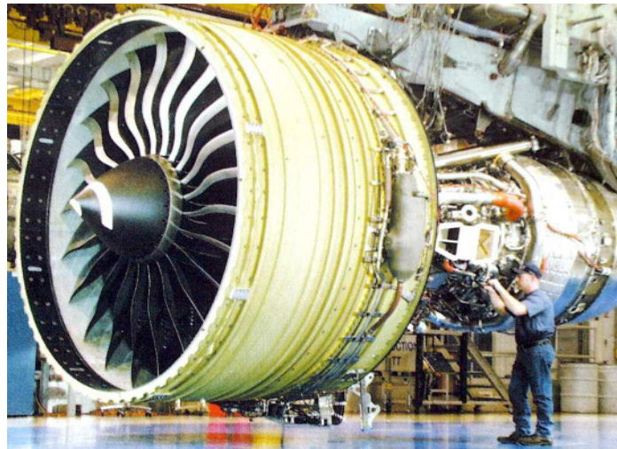
Abbildung 11: GE90 Fan-Schaufel, FVK-Schaufelblatt mit Ti-Vorderkante [3] (seit 1996 im Flugbetrieb)
