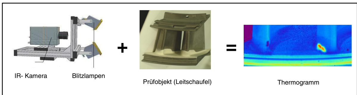
Abbildung 46: Messanordnung einer aktiven Thermografie [5]
