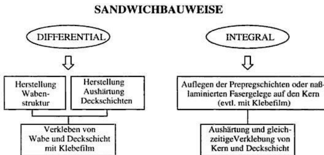
Abbildung 9: Sandwichstruktur in Differential- und Integralbauweise [1]
